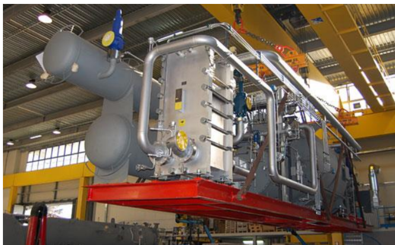
Figura 10 – ORC fabricado pela Turboden
